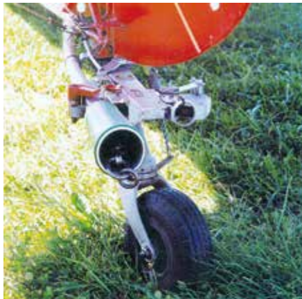
SEK eingebaut in PA25 mit Parallelbetrieb Schleppkupplung E85
