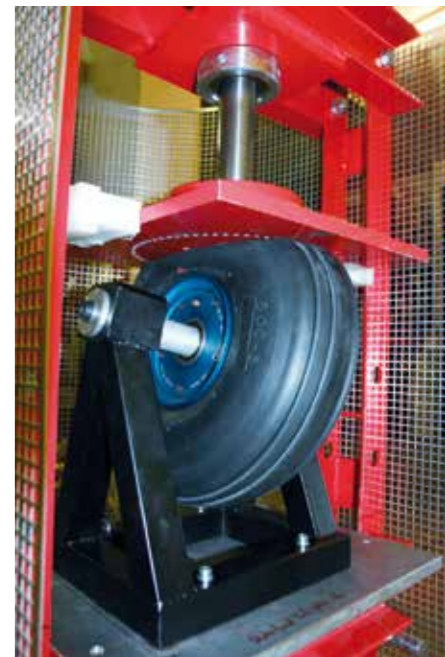
Statischer Belastungsversuch einer bereiften Felge
