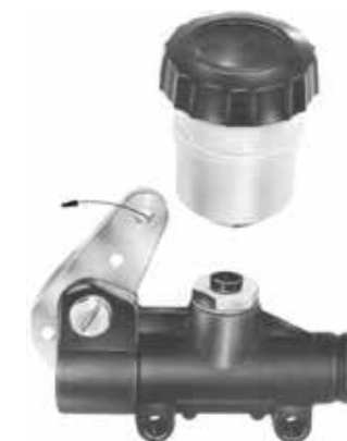
Universal-Hauptbremszylinder Form 7 mit Vorratsbehälter
