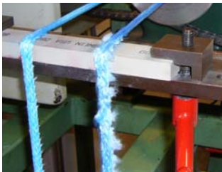
Seil links = DYNALAUNCH Sichtbar weniger Verschleiß bei gleicher Belastung
