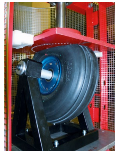
Statischer Belastungsversuch einer bereiften Felge
