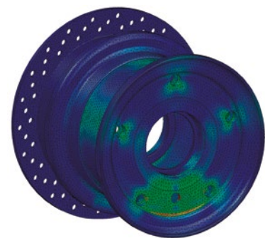
FEM-basierte Analyse eines Penta-Scheibenbremsrads
