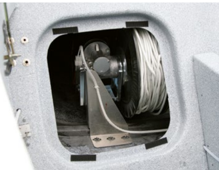
Windeneinheit eingebaut in Dynamic
