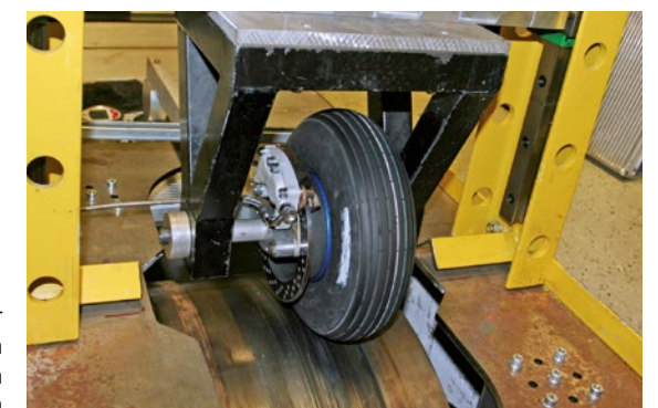
Systemtest zur realistischen Simulation von Landezyklen
