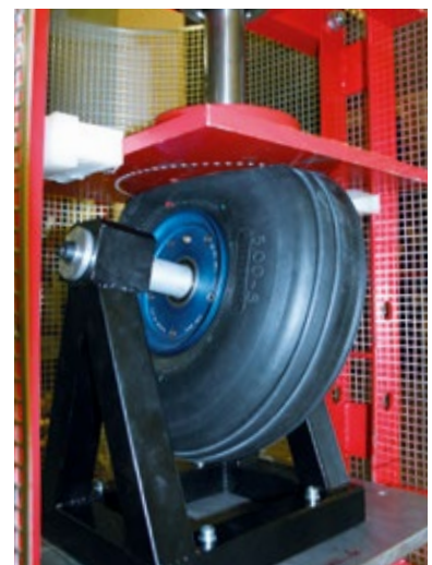
Statischer Belastungsversuch einer bereiften Felge
