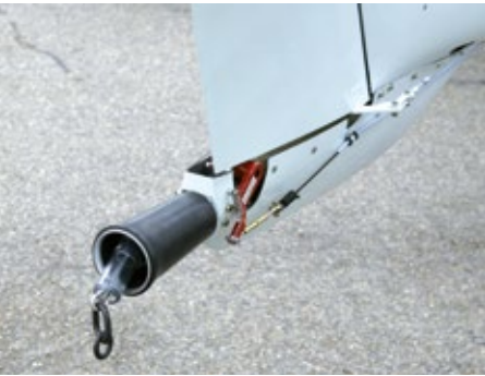
Zug- und Kappvorrichtung in MCR
