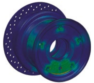
FEM-basierte Analyse eines Penta-Scheibenbremsrads
