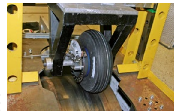
Systemtest zur realistischen Simulation von Landezyklen
