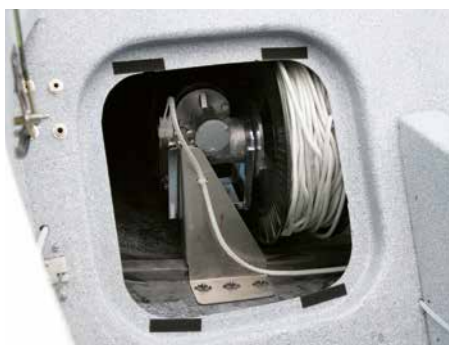
Windeneinheit eingebaut in Dynamic
