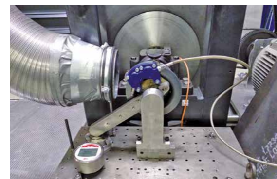
Bremstest mit Massenschwun- rad zur Ermittlung der Bremsleistung
