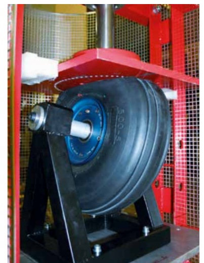
Statischer Belastungsversuch einer bereiften Felge
