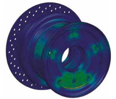
FEM-basierte Analyse eines Penta-Scheibenbremsrads
