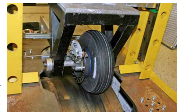
Systemtest zur realistischen Simulation von Landezyklen
